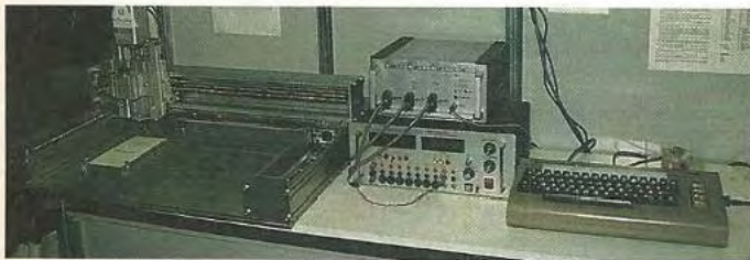
Bild 5. Ein professionell einsetzbares CNC-Frässystem für den C 64
